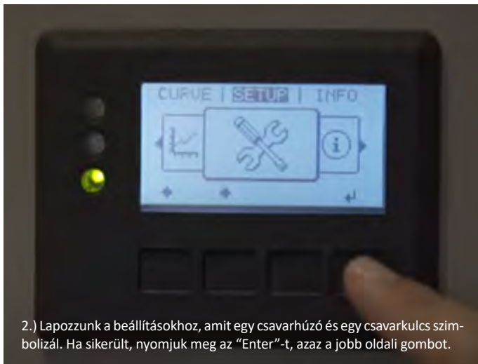
1.) Érintsük meg a kijelző alatti 4 gomb valamelyikét. Feltűnik a menürendszer, ahol a két bal oldali érintő gombbal lehet balra, illetve jobbra lapozni.
